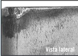
El **desgaste normal del flanco**, es la condición de desgaste más deseable, ya que es predecible y consistente.
