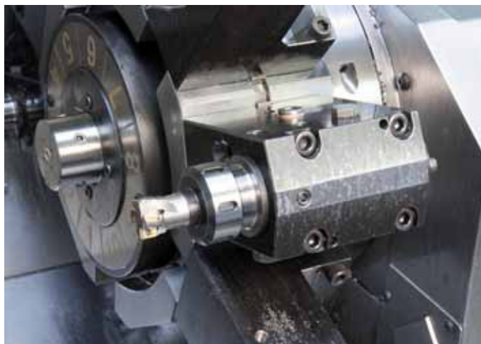
Víceúčelové stroje, rotační revolverové hlavy s vřeteny typu ER, osazené ER - adaptéry Combimaster a frézovacím nástrojovým systémem Combimaster.
