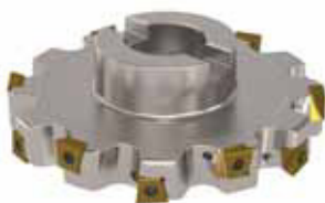
Typ B - s pevnými lůžky - šířka 15-20-25 mm Ø 80 - 250 mm Vnitřní chlazení do Ø 160 mm
