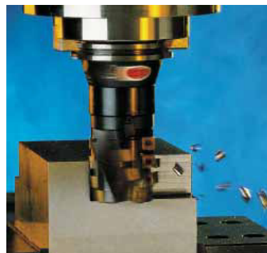
Výkonné frézování s modulárním systémem Graflex®: úběr materiálu 432 cm³/min
